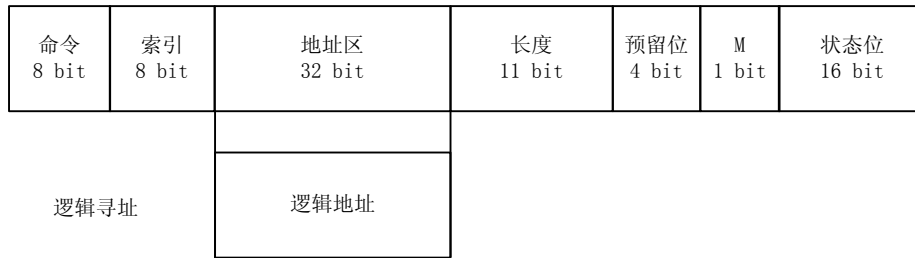
EtherCAT 逻辑寻址结构
